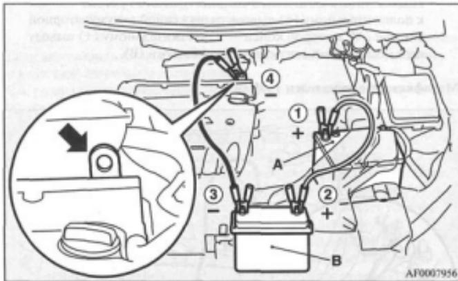
6. Подсоедините один конец другого соединительного провода к отрицательному (–) выводу вспомогательной аккумуляторной батареи, а второй конец — к блоку цилиндров двигателя автомобиля с разряженной аккумуляторной батареей, в точке, наиболее удаленной от аккумуляторной батареи.
