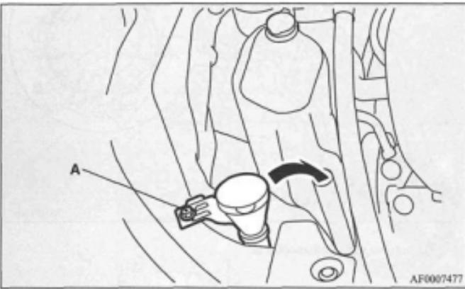
2. Поверните крышку (B) против часовой стрелки и затем извлеките ее.
