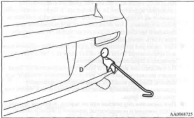
3. С помощью колесного ключа (E) вверните и надежно затяните буксировочную проушину (F).
