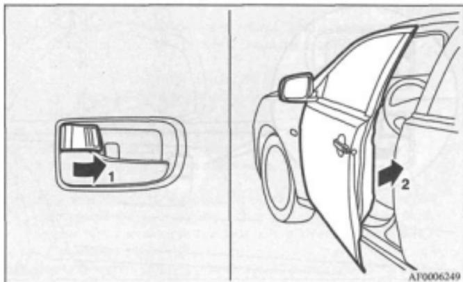
Установите кнопку запирания двери изнутри (1) в положение «заперто» и закройте дверь (2).
