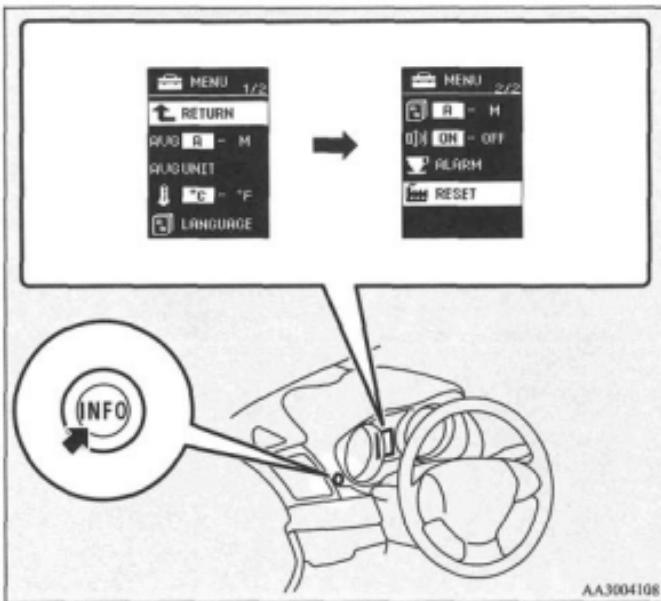
3. Удерживайте кнопку переключения нажатой не менее 5 секунд, при этом подается звуковой сигнал зуммера, и все значения параметров и функций будут установлены по умолчанию.
