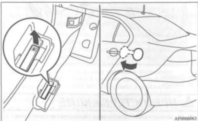
3. Откройте заливную горловину топливного бака, медленно поворачивая крышку против часовой стрелки.
