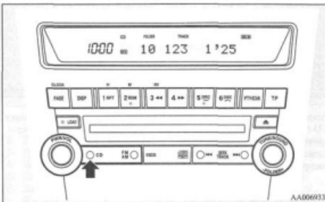
Если компакт-диск уже находится в проигрывателе, нажмите кнопку CD (2). На дисплее появится сообщение «READING», а затем начнется воспроизведение. На дисплее появится номер папки, номер воспроизводимой записи, время воспроизведения и индикатор MP3.
