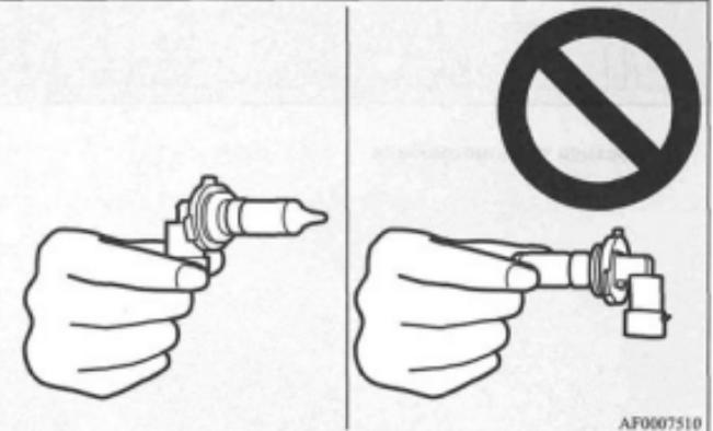
3. Лампа устанавливается в порядке, обратном снятию.
