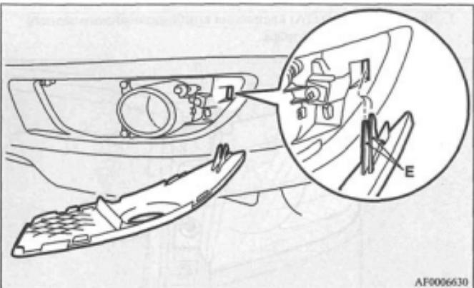
5. Для установки лампы выполните действия по снятию в обратной последовательности.
