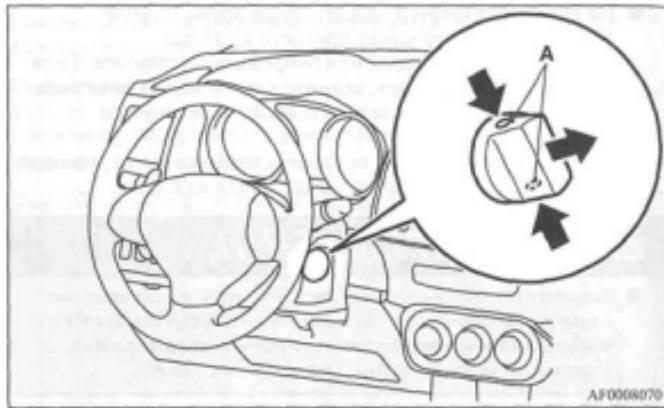
6. Вставьте вспомогательный ключ в замок зажигания.
