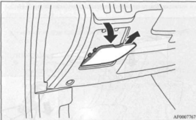
2. Если автомобиль оснащен нижней крышкой, съемником ослабьте 2 фиксатора (A) и нажмите на нижнюю крышку. Съемник расположен в блоке предохранителей моторного отсека. См. раздел «Замена предохранителей» на стр. 8-32.
