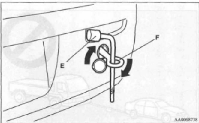
4. Закрепите буксирующий трос в буксировочной проушине. Другие указания аналогичны тем, что приведены в разделе «При буксировке автомобиля другим автомобилем».
